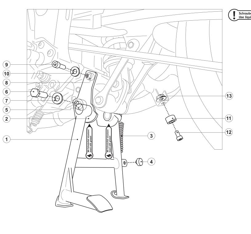
Schrauben mit flüssiger Schraubensicherung montieren! Use liquid thread locker to secure the screws!
