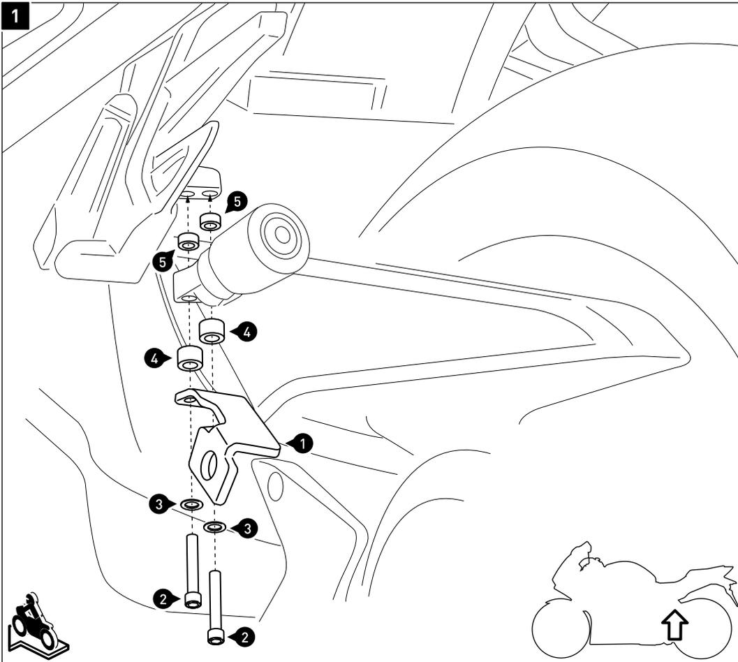
Entfernen Sie die originalen Schrauben und Distanzbuchsen vom Federvorspannversteller.
