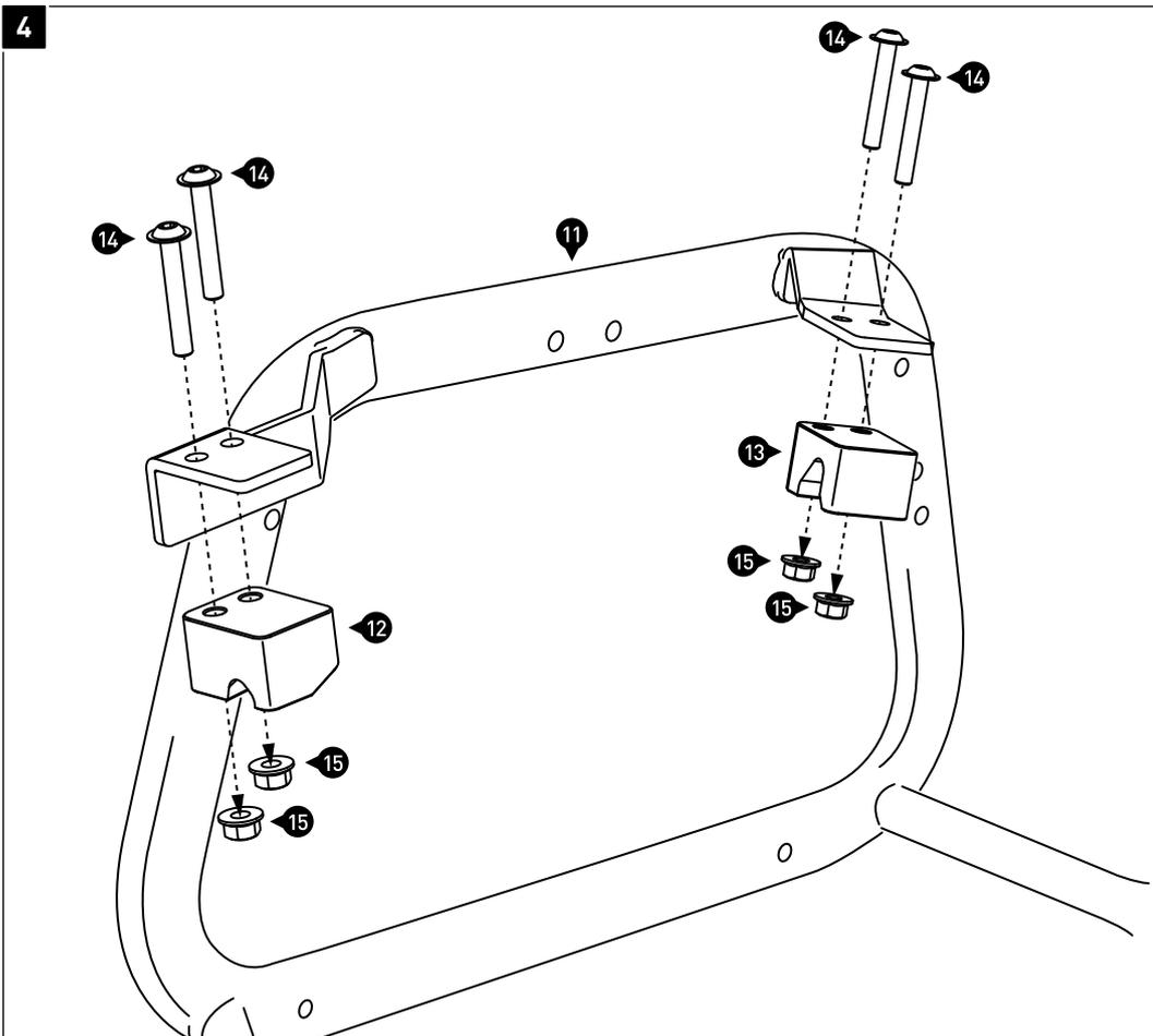
Verschrauben Sie die Einschubnasen (12) und (13) an den Kofferträger (11). Ziehen Sie die Schrauben wie in der Stückliste vorgegeben an.
