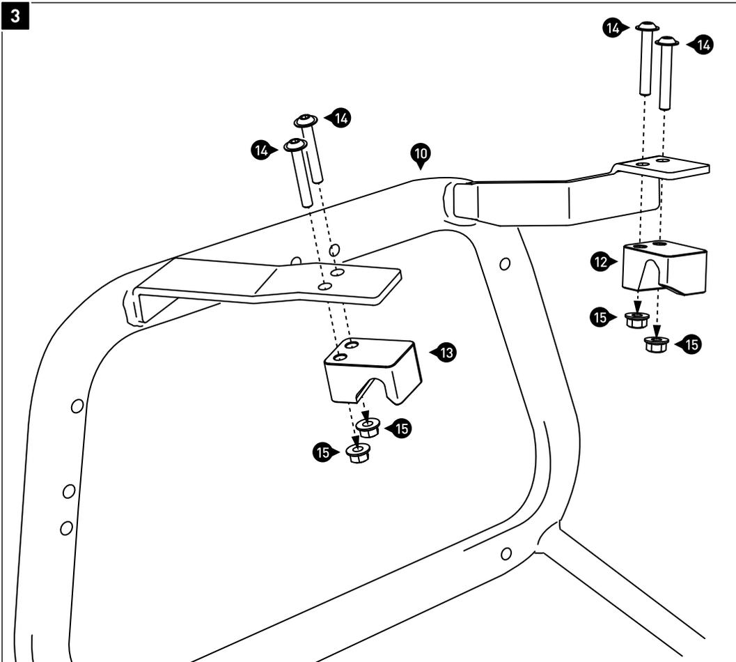
Verschrauben Sie die Einschubnasen (12) und (13) an den Kofferträger (10). Ziehen Sie die Schrauben wie in der Stückliste vorgegeben an.
