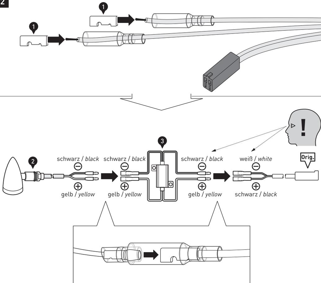
**ACHTUNG:** Achten Sie unbedingt auf die korrekte Verkabelung aller Steckverbindungen, da sonst die LED-Blinker beschädigt werden!
