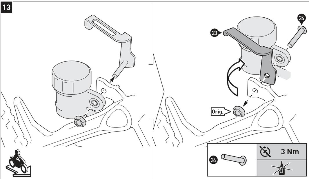
Entfernen Sie den Bremsflüssigkeitsbehälter vom rechten Soziusfußrastenhalter.
