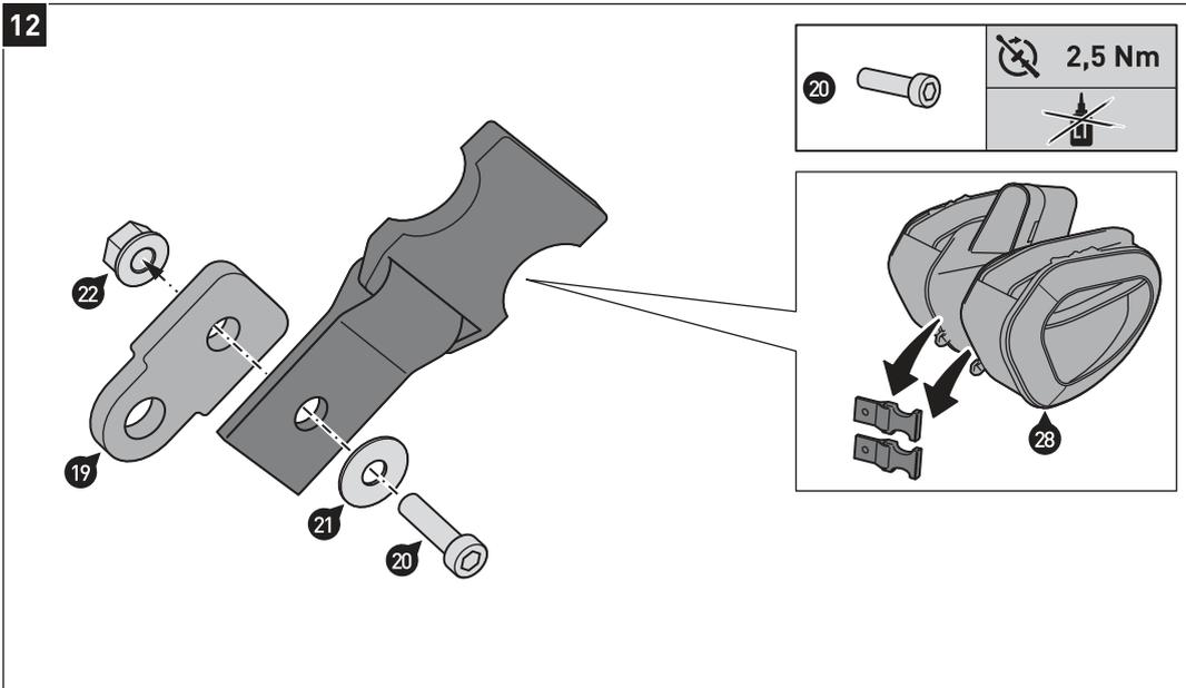
Entnehmen Sie die Klickverschlüsse Ihren Satteltaschen. Verschrauben Sie die Klickverschlüsse anschließend an den Befestigungslaschen (19), wie in der Zeichnung gezeigt. Ziehen Sie die Schrauben wie in der Stückliste vorgegeben an.
