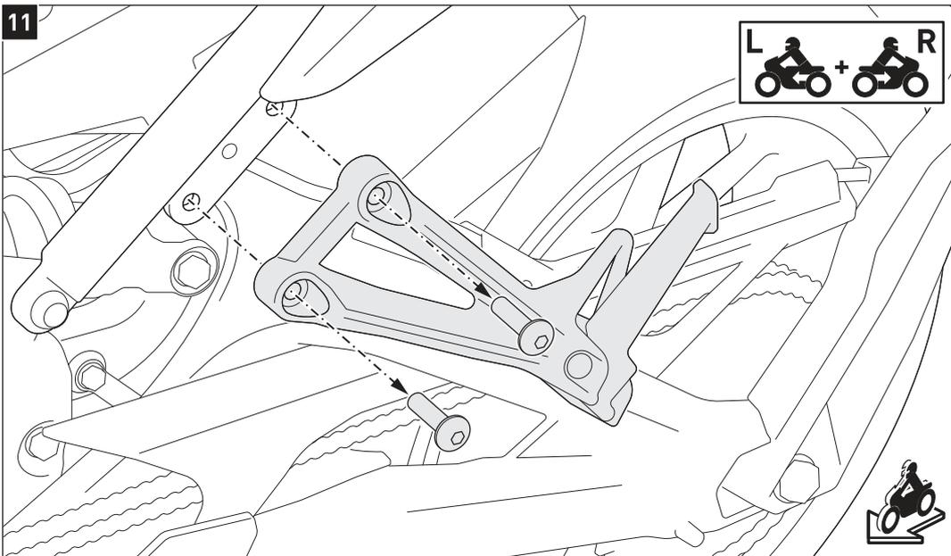
Entfernen Sie beidseitig die Original-Schrauben der Soziusfußrasten-Halter.
