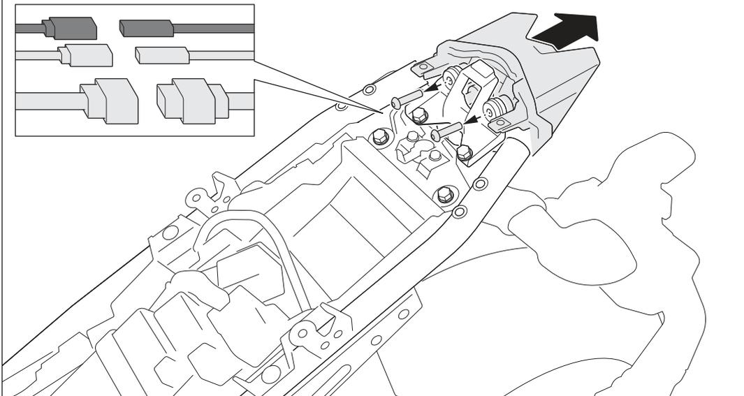
Lösen Sie die Steckverbindungen der Blinker und des Rücklichts.
