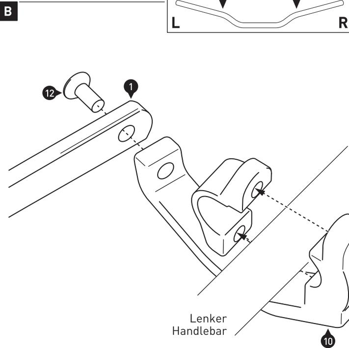
*HINWEIS:* Die Montage an den Anbaupunkten B ist linksseitig dargestellt. Wiederholen Sie die Montage mit den entsprechenden Teilen auf der rechten Lenkerseite analog zur linken Lenkerseite.
