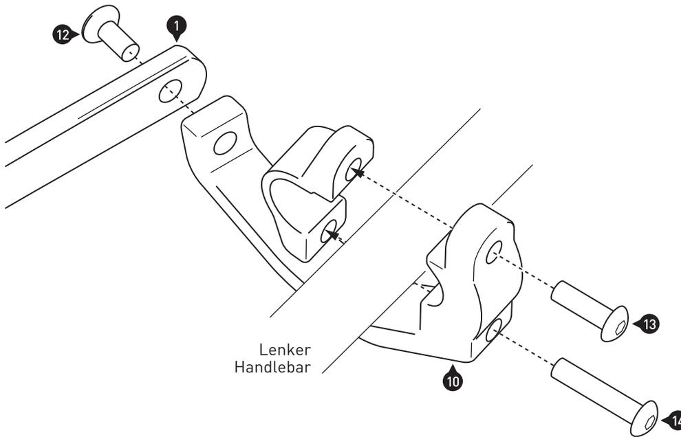
**HINWEIS:** Die Montage an den Anbaupunkten B ist linksseitig dargestellt. Wiederholen Sie die Montage mit den entsprechenden Teilen auf der rechten Lenkerseite analog zur linken Lenkerseite.
