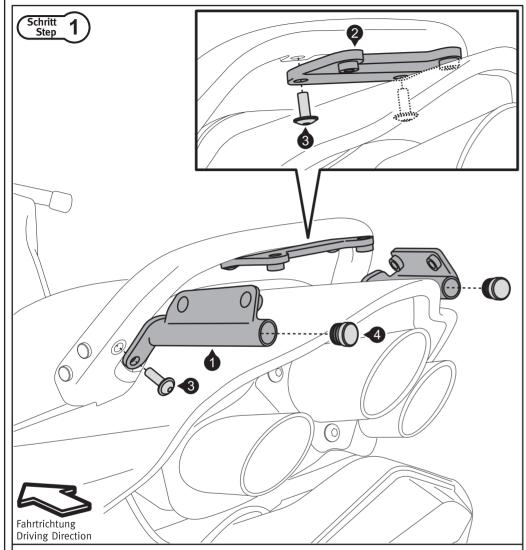
Sichern Sie die Schrauben (3) mit flüssiger Schraubensicherung.
