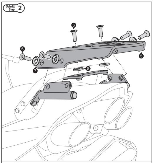
Verschrauben Sie das ALU-RACK (5) wie gezeigt. Sichern Sie die Schrauben (6) mit flüssiger Schraubensicherung. Anzugsmoment für die Schrauben (6): 20 Nm. Achtung: Falls die Montage einer Adapterplatte vorgesehen ist, MÜSSEN die Haltenocken am ALU-RACK vor dessen Anbau am Fahrzeug verschraubt werden.
