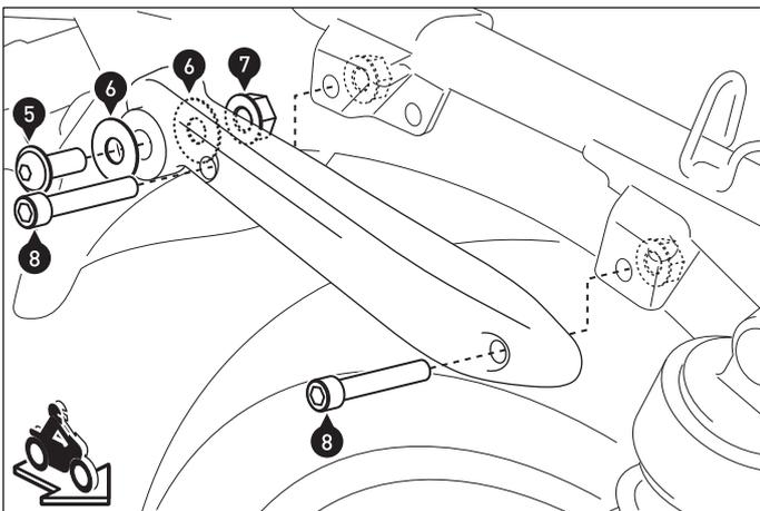
**12** Verschließen Sie die Blinkeröffnungen der Seitenstreben mit den gezeigten Teilen. Verschrauben Sie die Seitenstreben mit den Schrauben (8) und original Muttern am Fahrzeug. Ziehen Sie die Schrauben wie in der Stückliste vorgegeben an.
