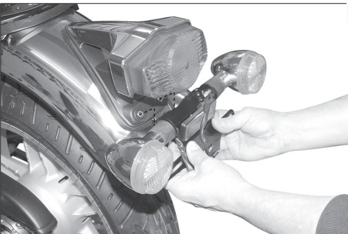
**8** Verschrauben Sie das Blinkerblech (1) ZWISCHEN Kennzeichenhalter und Rücklicht am Fahrzeug. Nutzen Sie die original Teile des Kennzeichenhalters.
