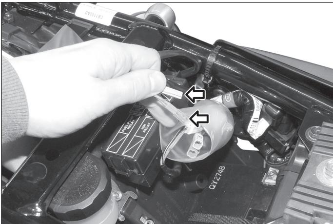
**2** Trennen Sie die Steckverbindungen der Blinkerkabel (Orange und Blau).
