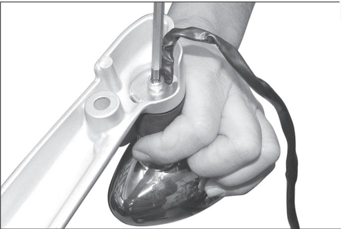
**5** Lösen Sie die gezeigten Schrauben und entfernen Sie die Blinker von den Seitenstreben.
