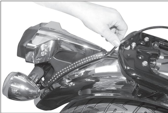
**9** Verlegen Sie die Blinkerkabel vorsichtig unter dem Rücklicht; ziehen Sie die Schraubverbindungen vom Rücklicht und Kennzeichenhalter nach Fahrzeugherstellerrangaben an.
