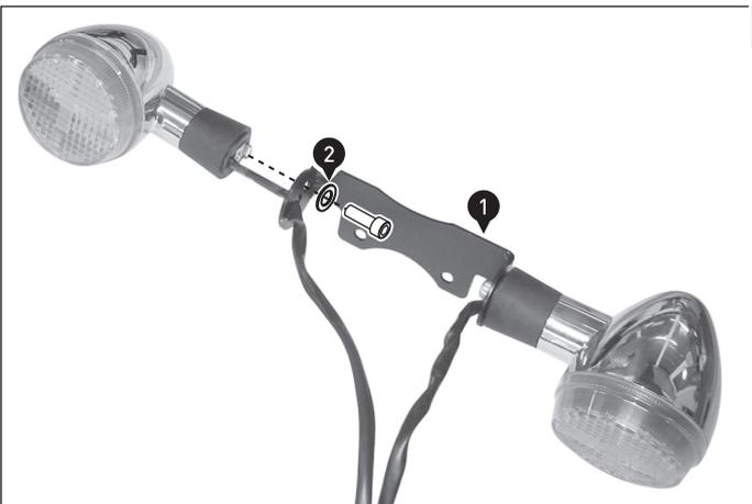
**7** Befestigen Sie die Blinker mit den original Schrauben und Unterlegscheiben (2) am Blinkerblech (1).
