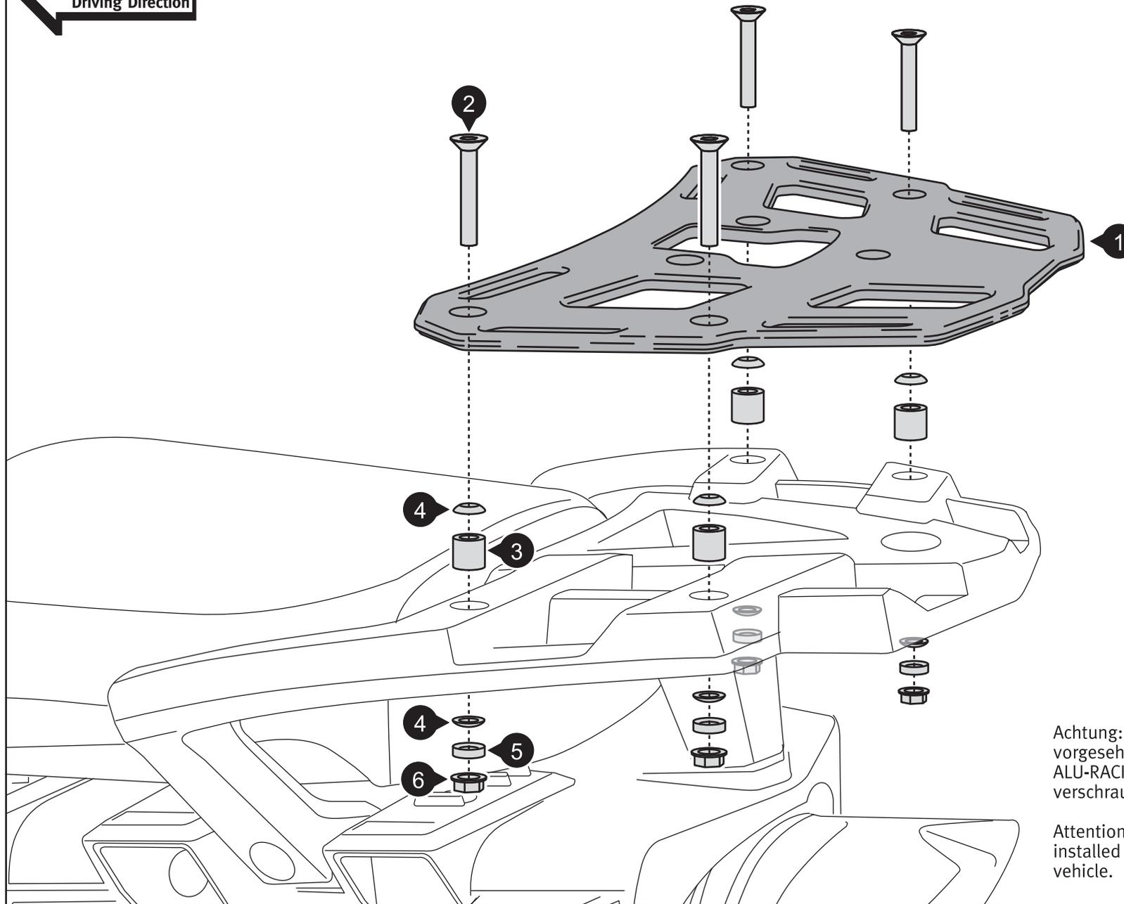
Achtung: Falls die Montage einer Adapterplatte vorgesehen ist, MÜSSEN die Haltenocken am ALU-RACK vor dessen Anbau am Motorrad verschraubt werden.
