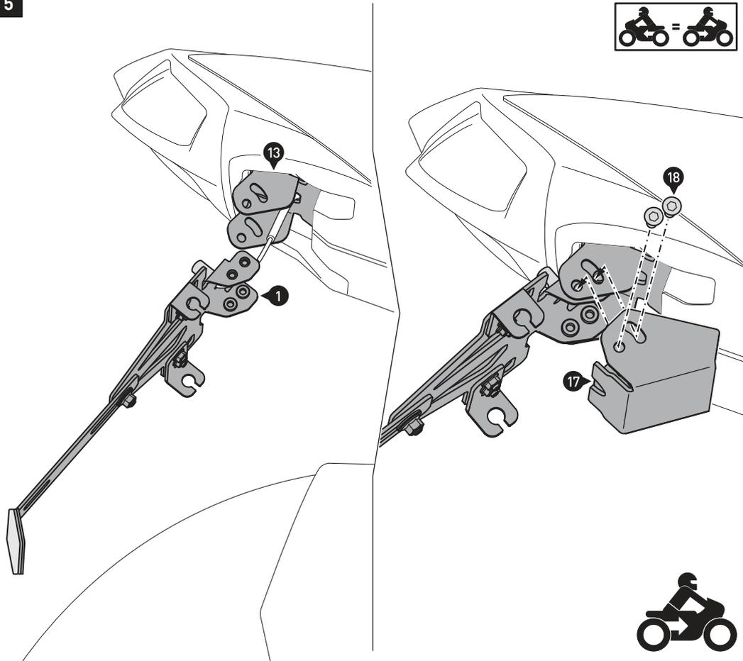
Ziehen Sie das Kabel der Kennzeichenbeleuchtung durch die Öffnung ins Innere des Hecks und verbinden Sie die weißen Stecker.
