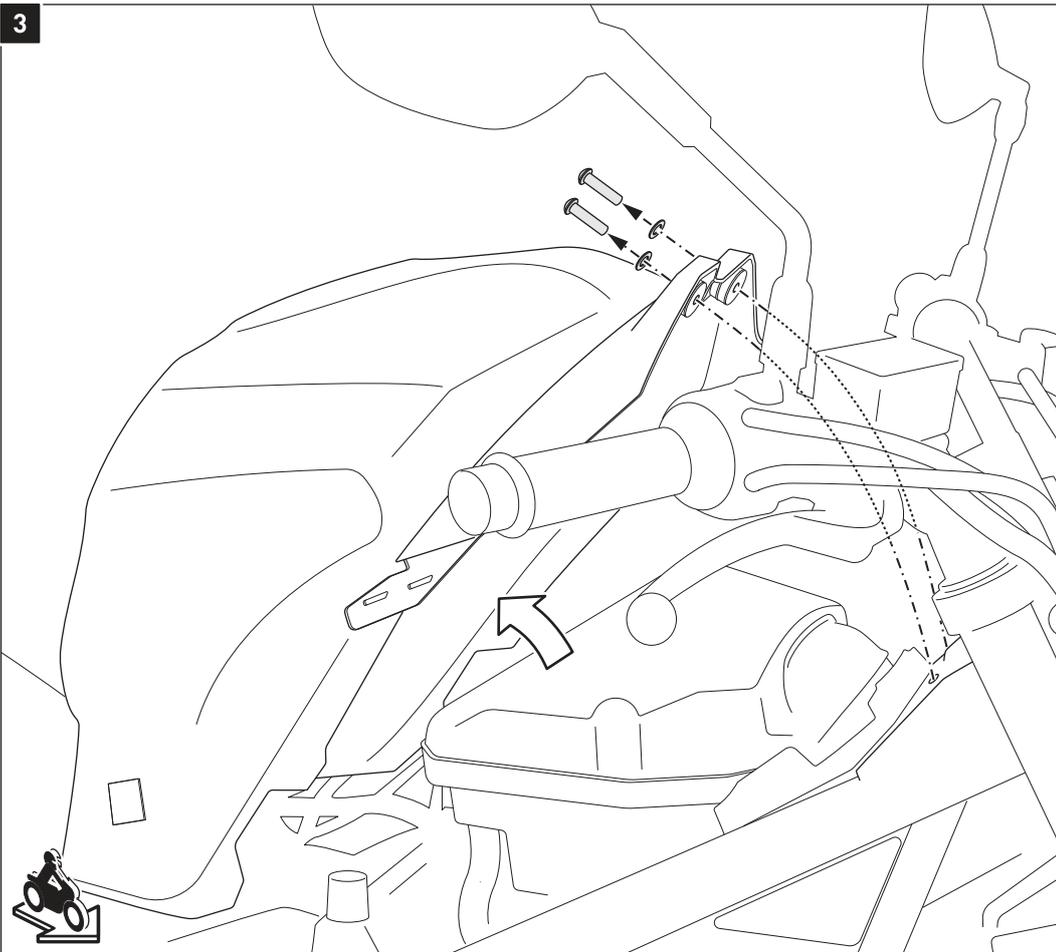
Entfernen Sie die gezeigten originalen Schrauben und heben Sie die Tankabdeckung an. Stützen Sie diese mit einem geeigneten Heber ab.
