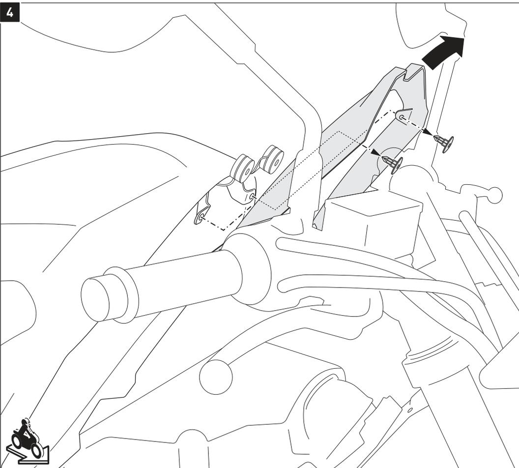
Lösen Sie die gezeigten Spreizclips durch leichten Druck in die Kopf-Öffnung. Entfernen Sie das originale Verkleidungsteil vom Fahrzeug, wie in der Zeichnung gezeigt.
