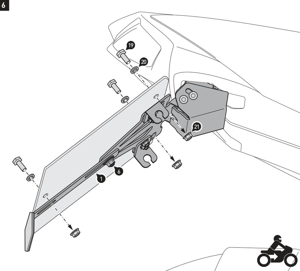
Montieren Sie das Kennzeichen am Kennzeichenträger, wie in der Zeichnung gezeigt. Ziehen Sie die Schrauben (6) und (19) wie in der Stückliste vorgegeben an.
