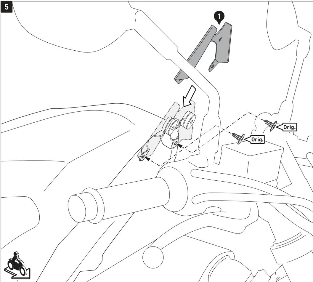
Verbauen Sie das Abdeckblech (1) mit den originalen Spreizclips (Orig.) am Fahrzeug, wie in der Zeichnung gezeigt.
