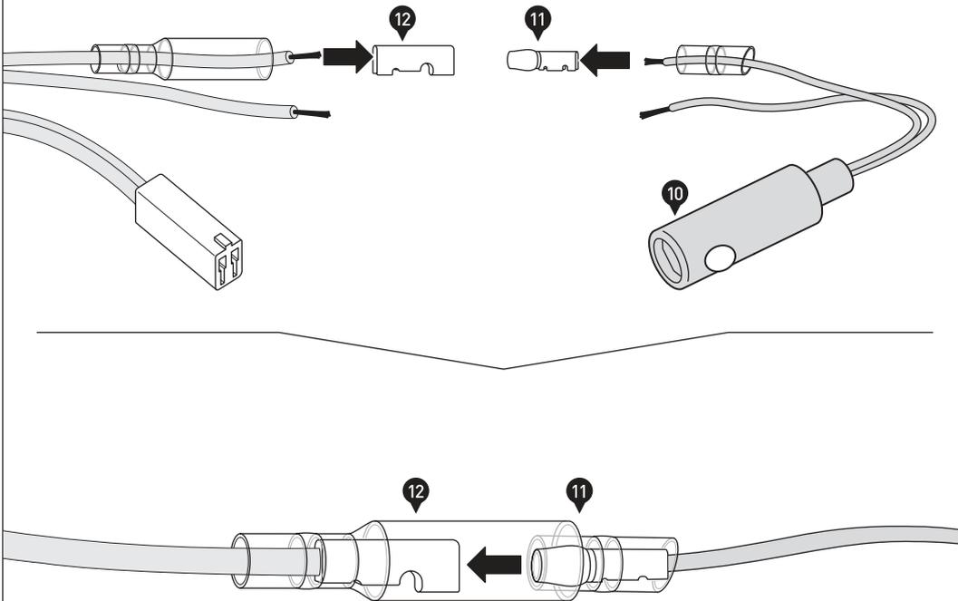
Isolieren Sie die Enden des Leuchtschraubenkabels (10) und des Kennzeichenbeleuchtungskabels ab.
