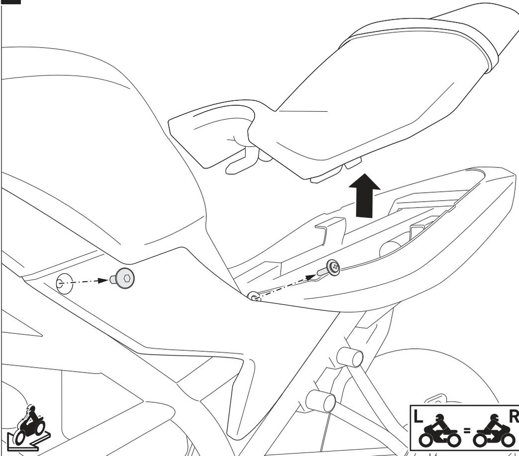
Entfernen Sie die Sitzbank und beidseitig die Schrauben und Spreizclips der Verkleidungsteile, wie in der Zeichnung gezeigt.
