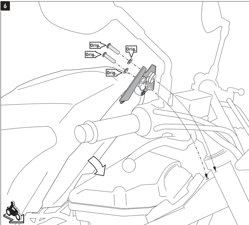
Verschrauben Sie die Tankabdeckung wieder mit den originalen Schrauben und Unterlegscheiben (Orig.) am Fahrzeug. Ziehen Sie die originalen Schrauben nach Herstellerangaben an.
