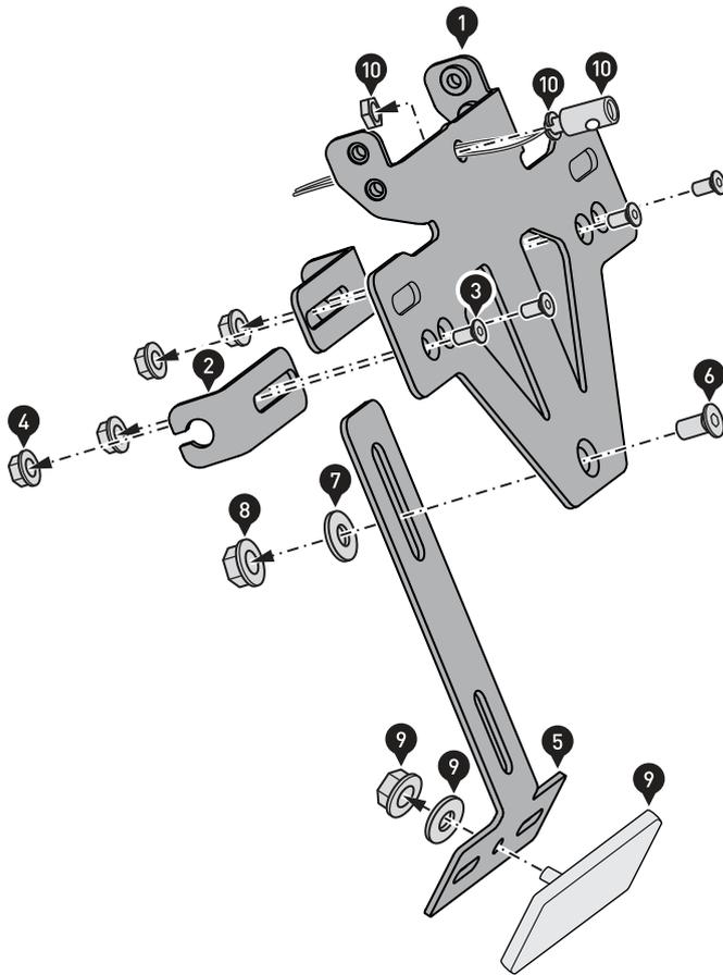
Verschrauben Sie die Blinkerbleche (2) und das Reflektorblech (5) am Kennzeichenhalter (1), wie in der Zeichnung gezeigt.
