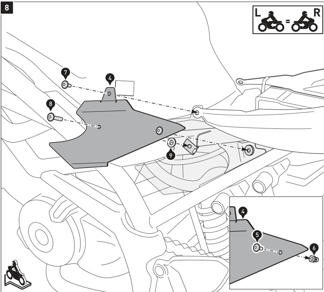
Verschrauben Sie die Kugelbolzen (6) mit den Schrauben (5) an den Rahmenabdeckungen (4), wie in der Detailzeichnung gezeigt.
