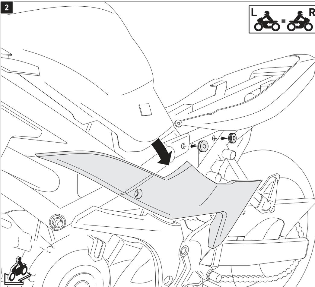
Entfernen Sie beidseitig die Verkleidungsteile und die Gummidämpfer vom Fahrzeug, wie in der Zeichnung gezeigt.
