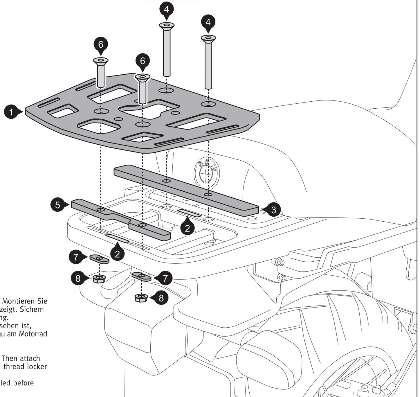
Entfernen Sie den originalen Haltegriff vom Fahrzeug. Montieren Sie anschließend das ALU-RACK, wie in der Zeichnung gezeigt. Sichern Sie die Schrauben (4) mit flüssiger Schraubensicherung. Achtung: Falls die Montage einer Adapterplatte vorgesehen ist, MÜSSEN die Haltenocken am ALU-RACK vor dessen Anbau am Motorrad verschraubt werden.
